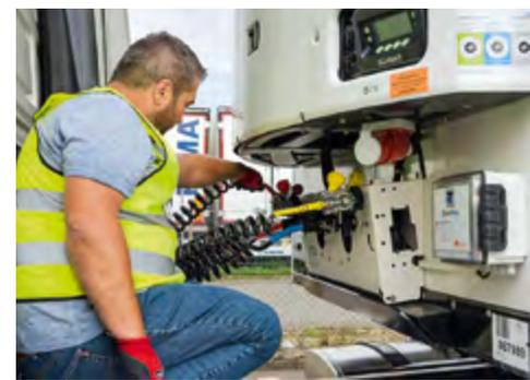
Die Bremsleitung (gelber Kupplungskopf) wird stets zuerst angeschlossen.
